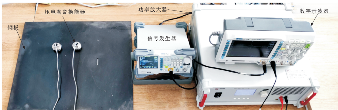
图 12 Lamb 波检测试验装置
