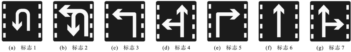
图 3 车道行驶方向标志 Fig. 3 Lane directional signs
