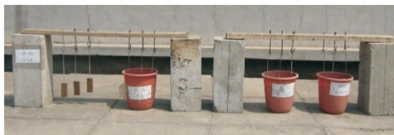
图 1 腐蚀挂片试验装置
