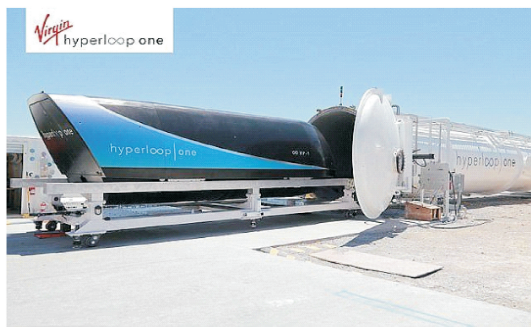
图 7 美国 Hyperloop One 公司研制的真空管道磁悬浮车辆
