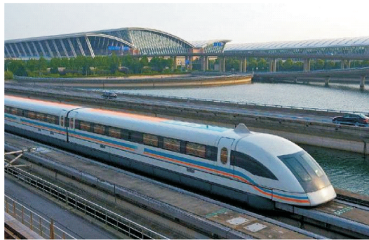
图 8 德国 EMS 磁悬浮车 TR08 在上海浦东机场线
