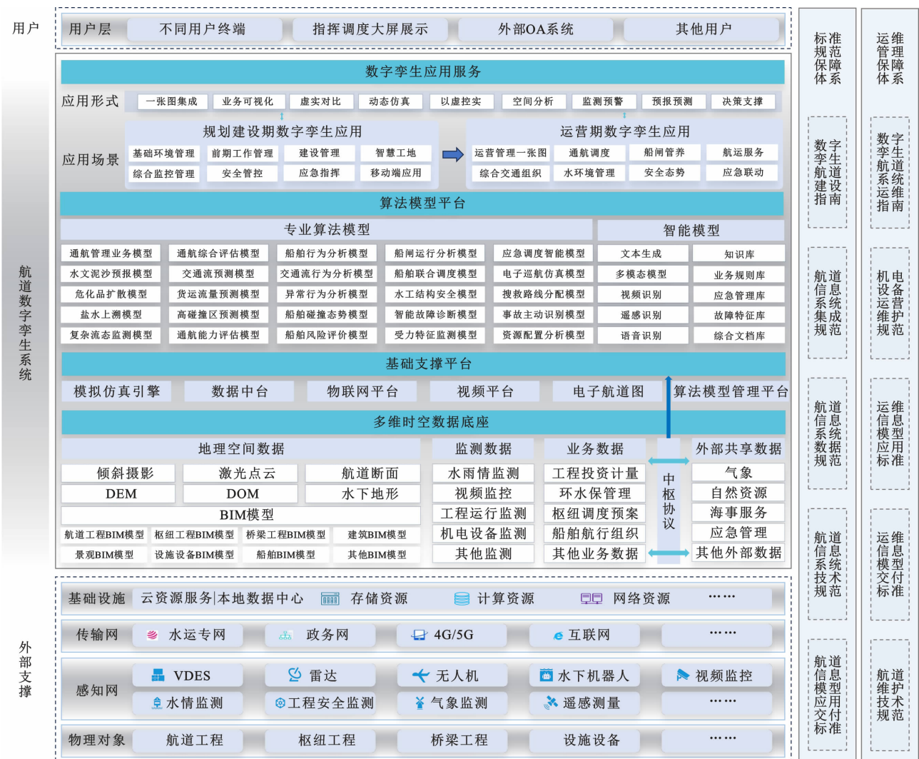
图 9 面向全生命周期的航道数字孪生系统架构
