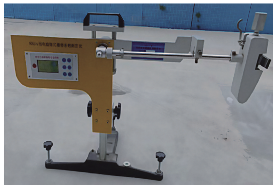
图5 摆式摩擦因数测定仪
