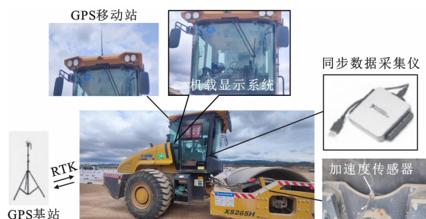
图1 智能压实系统组成
