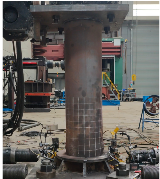
图 9 PCFST 桥墩拟静力试验试件
