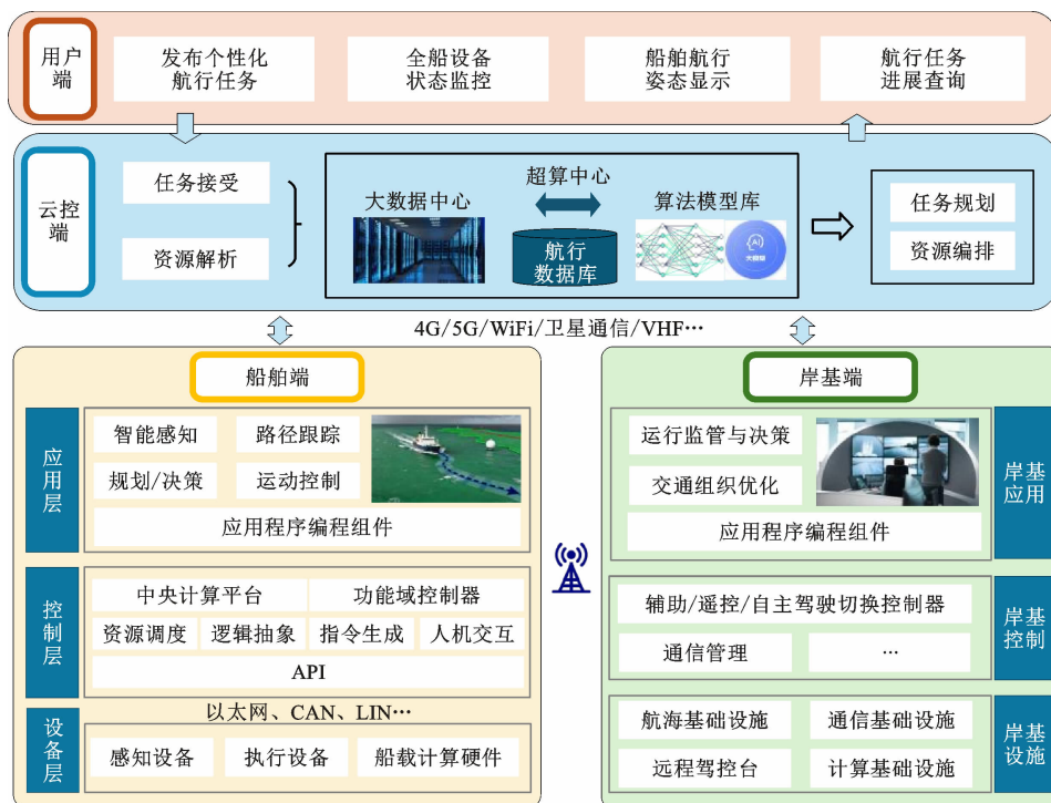
图4 基于中央集中式 EEA 的软件定义智能船舶航行控制架构
